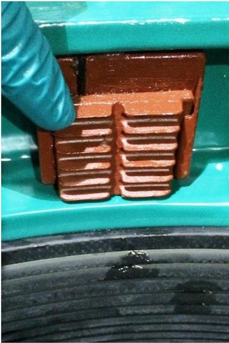
**4. MAKE SURE THAT THE GRIPPERS ARE PUSHED ALL THE WAY TOWARDS THE GASKET AS SHOWN IN THIS PICTURE.**
